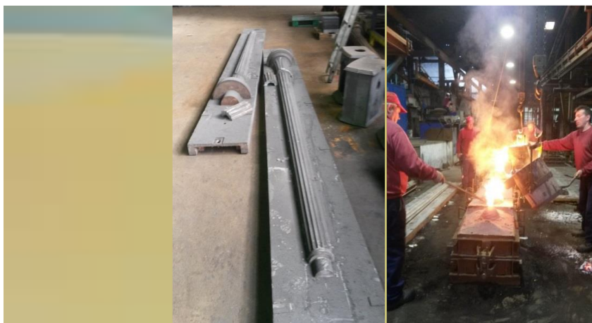
Figura 5 – Processo de Produção de uma Coluna de Ferro Fundido
